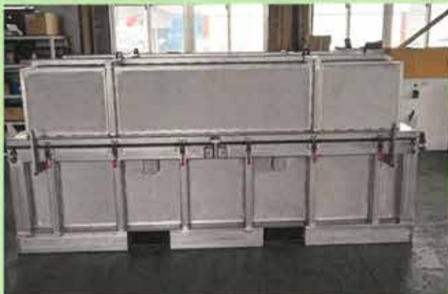
① オールステンレス密閉容器 (SUS304) (サイズ: 1845 × 2800 × 高さ1355)
