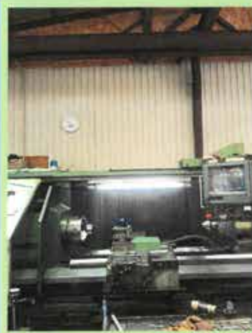
NC旋盤 最大加工径: \phi 360 mm (チャックワーク時 \phi 600 mm) 最大加工長さ: 3000mm 最大重量 1.5ton
