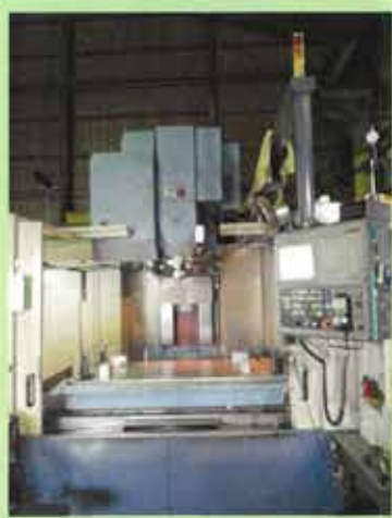
NC縦型マシニングセンター 左右移動: 1500mm 前後移動: 660mm 最大高さ: 800mm 最大重量 2.0ton
