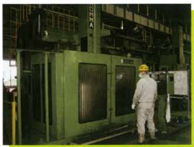
縦型NC旋盤 / HONMA テーブルサイズ 1600 加工最大重量 10t 加工最大径 1600mm 加工最大長 1100mm
