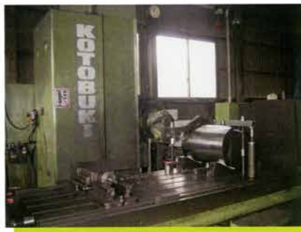
NC フライス盤 / 寿工業 移動量 (XYZ) X2450 Y1000 Z1035
