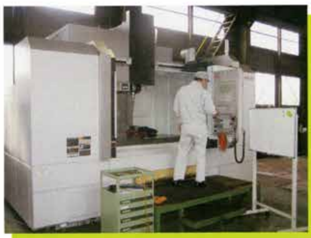
2019.5 新規導入 NC 縦型マシニングセンター テーブルサイズ 1700×760 最大積載量 2000kg 移動量 (XYZ) X1540 Y760 Z660
